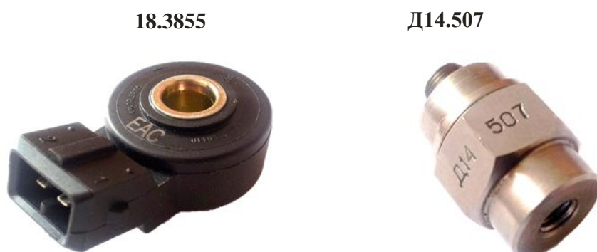
Рисунок 3 – Вибродатчики, выбранные для исследований
