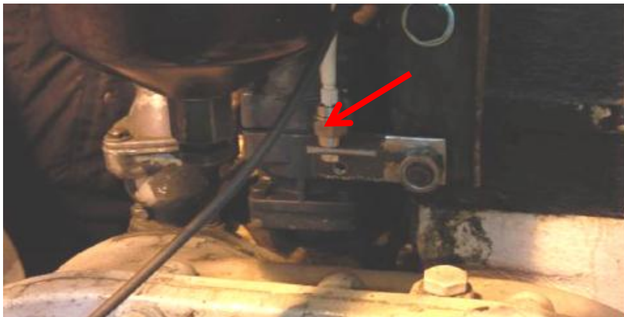
Рисунок 5 – Вибродатчик, закрепленный на головке блока цилиндров дизельного ДВС К461М1
