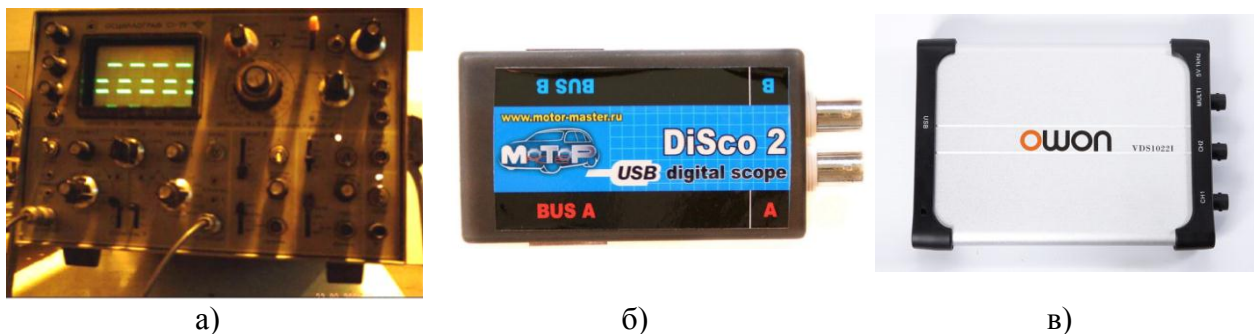
Рисунок 7 – Электронно-лучевой (а) и цифровые (б и в) осциллографы, использованные в экспериментах
