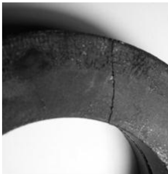
Рисунок 9 – Разрушение ферритного тороидального магнитопровода под воздействием магнитострикционного эффекта
