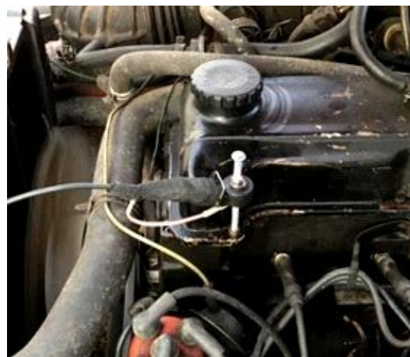
Рисунок 6 – закрепление вибродатчиков Д14.507 (а) и 18.3855 (б) на головке блока цилиндров ДВС GM20E
